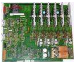
Antriebsplatte Große Leistung 25 A
