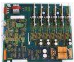
Antriebsplatte Kleine Leistung 1,1 A / 2,1 A
